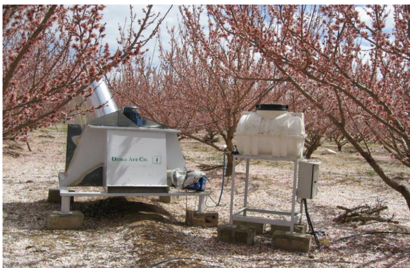
شکل ۲۵: نمای از دستگاه جدید دمنده هوای گرم مورد استفاده به منظور مقابله با سرمازدگی
