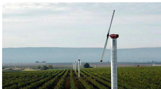
شکل ۱۷: نمای از ماشین مولد باد مورد استفاده در یک باغ به منظور مقابله با سرمازدگی
